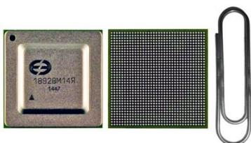
Малопотребляющий многоядерный сигнальный микропроцессор 1892ВМ14Я для связных, навигационных, мультимедийных, встраиваемых, мобильных приложений, например: промышленных компьютеров, планшетов, тонких клиентов, средств защиты информации, IP-видеокамер, IP-телефонов.
