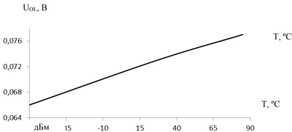
Рисунок 7.6 – Зависимость выходного напряжения низкого уровня  $U_{OL}$  от температуры при  $I_{OL} = 4 \text{ мА}$ ,  $U_{CCD} = U_{CCA} = U_{CCK} = 3,13 \text{ В}$
