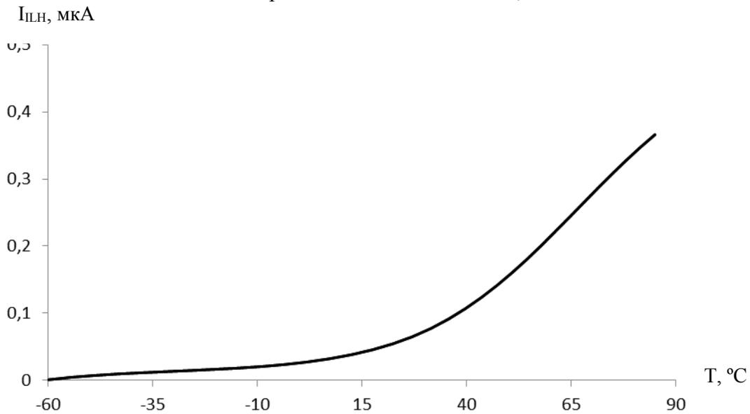
Рисунок 7.8 – Зависимость тока утечки высокого уровня  $I_{ПН}$  от температуры при  $U_{ПН}=3,67 \text{ В}$ ,  $U_{CCD} = U_{CCA} = U_{CCK} = 3,47 \text{ В}$
