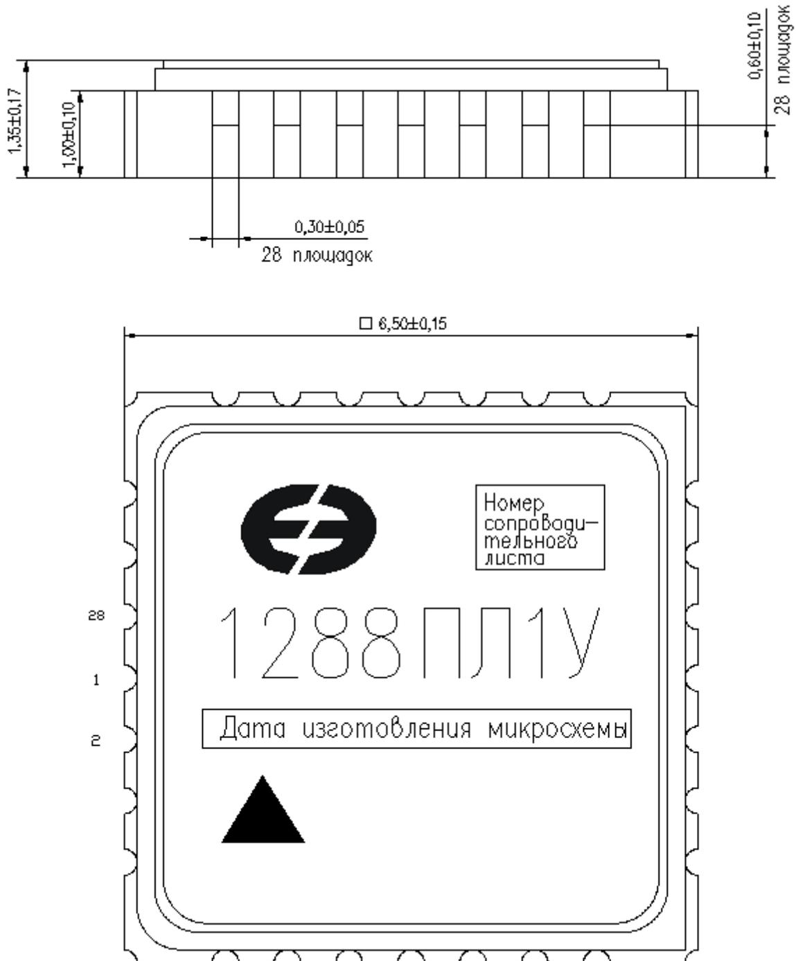
Рисунок 10.1 (лист 1 из 2). Условное обозначение корпуса: МК 5123.28-1.
