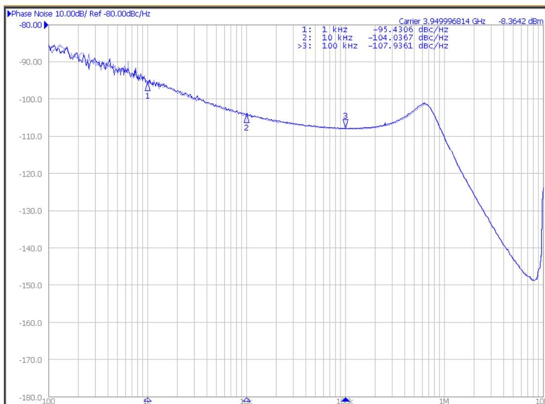
Рисунок 7.1 – Зависимость фазового шума [дБн/Гц] синтезатора частоты (на основе микросхемы 1288ПЛ1У и генератора, управляемого напряжением ROS-4077-119+) от отстройки от синтезируемой частоты [Гц] при  $U_{\text{ССК}} = U_{\text{ССД}} = U_{\text{ССА}} = 3,3 \text{ В}$  с параметрами синтезатора частоты: полоса пропускания 1 МГц, синтезируемая частота 3,95 ГГц, частота сравнения частотно-фазового детектора 10 МГц
