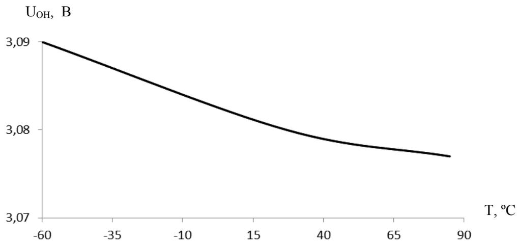
Рисунок 7.5 – Зависимость выходного напряжения высокого уровня  $U_{OH}$  от температуры при  $I_{OH} = \text{минус } 2,8 \text{ мА}$ ,  $U_{CCD} = U_{CCA} = U_{CCK} = 3,13 \text{ В}$
