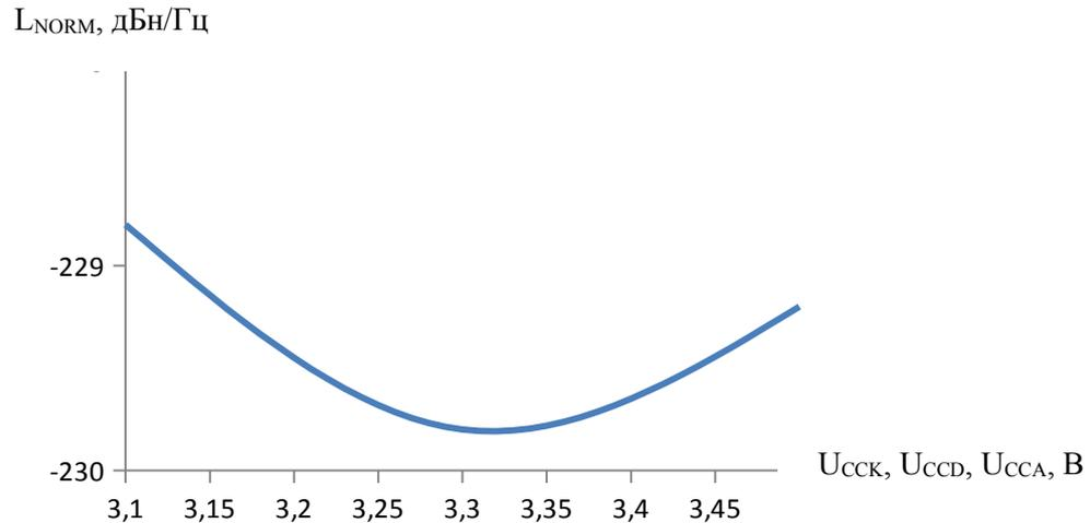
Рисунок 7.2 – Зависимость уровня приведенных фазовых шумов
