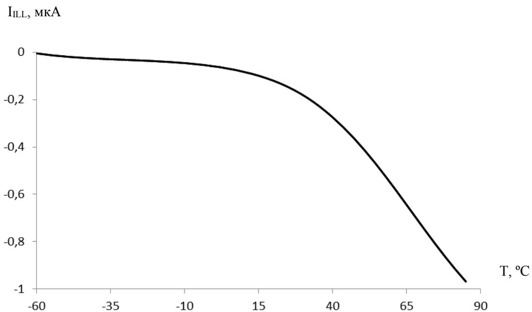
Рисунок 7.9 – Зависимость тока утечки низкого уровня  $I_{ПН}$  от температуры при  $U_{ПН} = \text{минус } 0,2 \text{ В}$ ,  $U_{CCD} = U_{CCA} = U_{CCK} = 3,47 \text{ В}$
