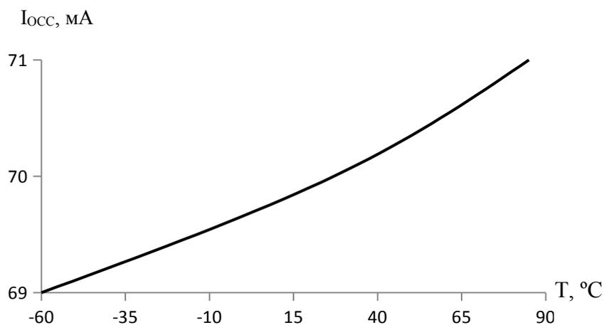
Рисунок 7.4 – Зависимость динамического тока потребления от температуры при
