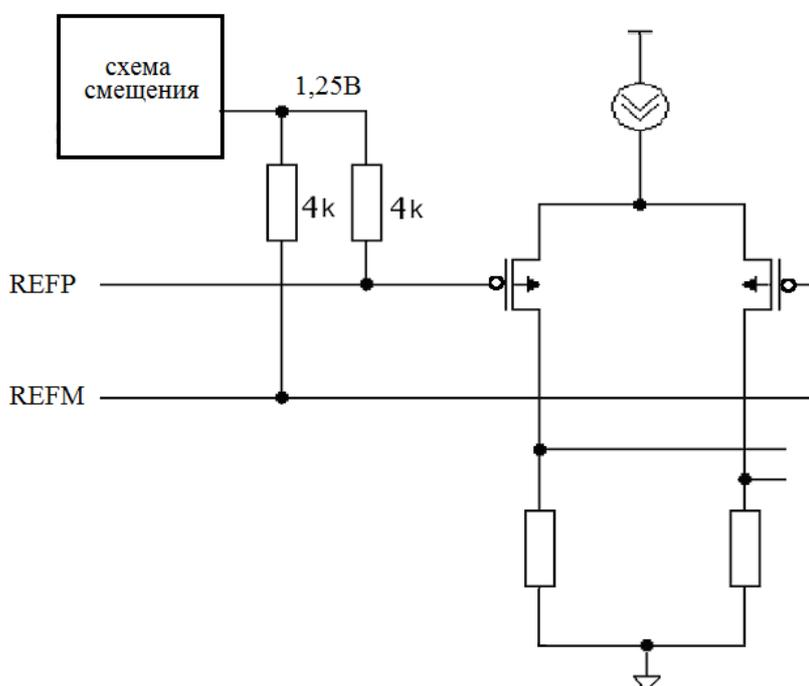
Рисунок 4.2. Эквивалентная схема входа приемника опорной частоты
