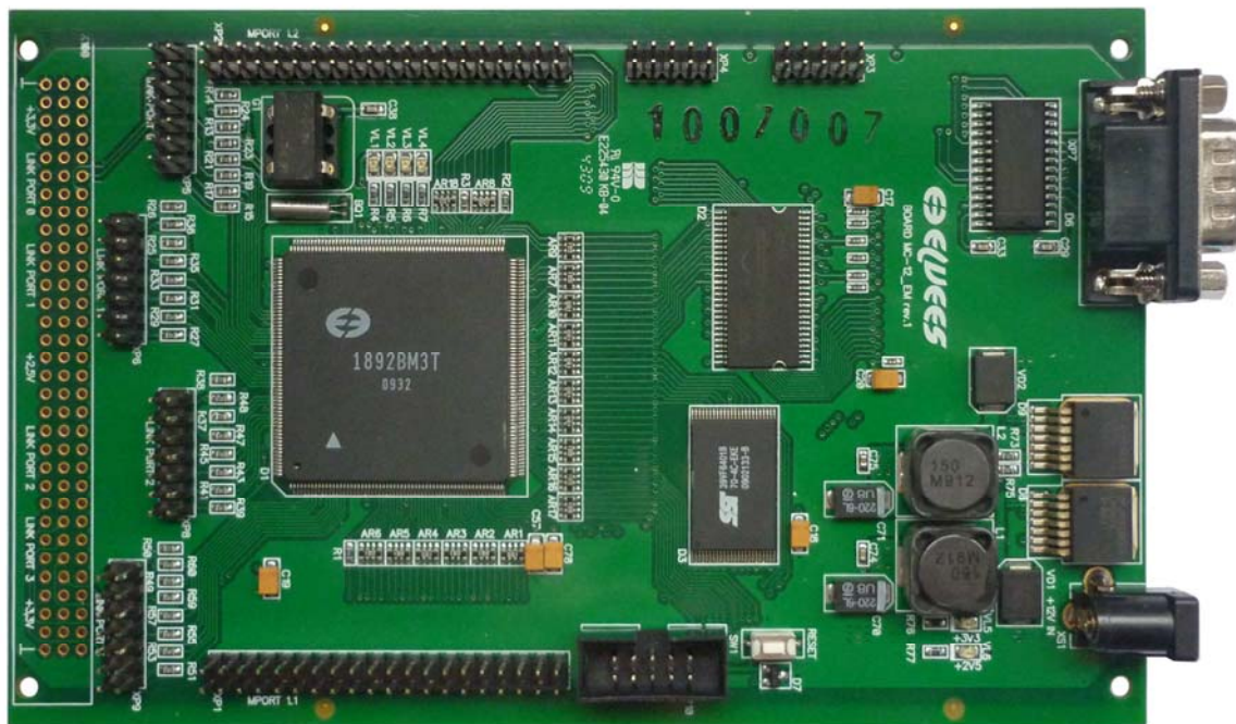
Рисунок 2.3. Внешний вид отладочного модуля. Лицевая сторона платы
