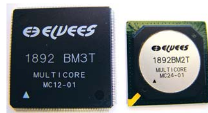
Рис. 2. Отладочный комплект для микросхемы MC-12, фото микросхем 1892BM3T (MC-12) и 1892BM2T (MC-24)
