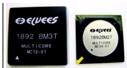
Рисунок 1 Микросхемы серийных сигнальных контроллеров серии “Мультикор”: 1892BM3T (MC-12) и 1892BM2T (MC-24)
