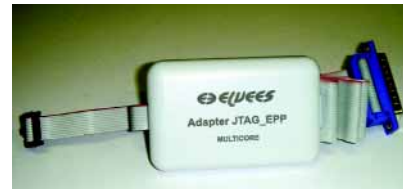
Рисунок 9 "Адаптер связи EPP-JTAG" для сигнальных контроллеров серии "Мультикор"
