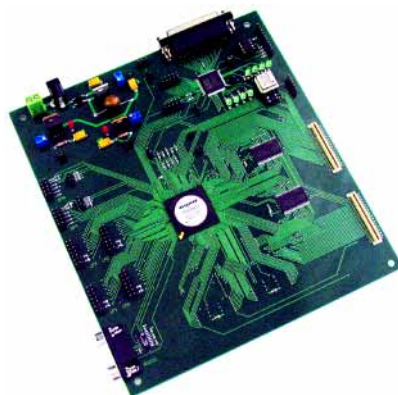
Рисунок 8 Отладочная плата для микросхемы 1892BM2T
