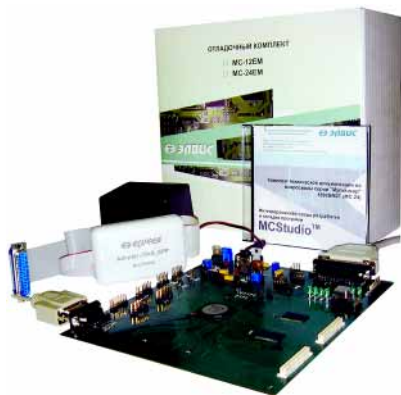
Рисунок 7 Отладочный комплект для микросхемы 1892BM3T (MC-12)
